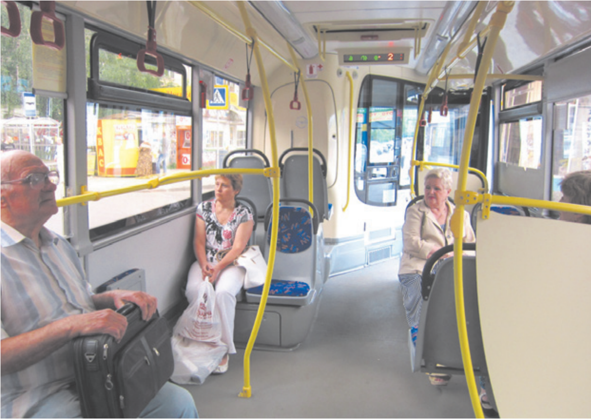
На площадке для проезда инвалидной или детской колясок смонтированы откидные сидения, на которых в отсутствие таких пассажиров тоже можно присесть
